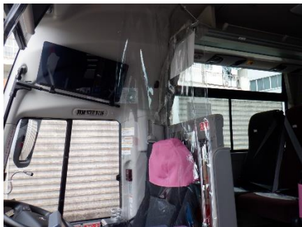
ビニールカーテン等の仕切りの設置
